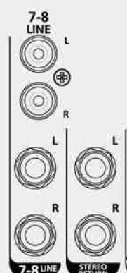
**Entrée RCA LINE (Can. 7/8)** Permet de brancher les équipements bas de gamme ou grand public, tels que les lecteurs de CD, les ordinateurs et les téléphones mobiles (adaptateur requis). L'entrée LINE (Can. 7/8) est également répliquée avec un jack 6,35 mm..
