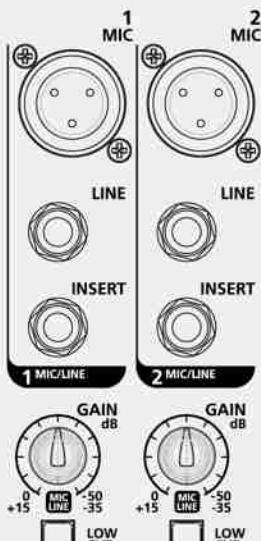
**MIC Eingang (K. 1 - K. 5/6)** Schließen Sie Ihre Mikrofone an diese symmetrischen XLR Verbinder an: Pin1=Erde, Pin2=Hot, Pin3=Cold. Diese Eingänge haben eine +48 V Phantomspeisung für Kondensator- oder Elektret-Mikrofone. Gain Regelung 0 dB/-50 dB.
