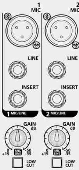
**Entrée MIC (Can. 1 - Can. 5/6)** Permet de connecter les micros aux connecteurs XLR équilibrés suivants : Broche 1 = Terre, Broche 2 = Point chaud, Broche 3 = Point froid. Ces entrées sont fournies avec une alimentation fantôme de +48 V pour les microphones à condensateur ou à électret. Échelle de gain 0 dB/-50 dB.
