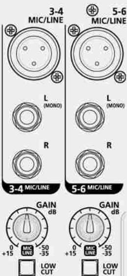
**Entrée STEREO LINE (Can. 3/4 - Can. 5/6)** Permet de brancher le clavier et les équipements stéréo ou de niveau de ligne. Échelle de gain +15 dB/-35 dB (Can. 3/4 - Can. 5/6). Le canal correspondant fonctionne comme un canal mono lorsque l'entrée MIC 3-4 ou 5-6 est utilisée.
