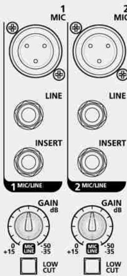
**Entrada MIC (canal 1 - canal 5/6)** Los micrófonos se conectan a estos conectores XLR balanceados; clavija 1=tierra, clavija 2=fase, clavija 3=contrafase. Estas entradas reciben alimentación fantasma de +48 V para micrófonos de condensador o electret. Escala de ganancia 0 dB/-50 dB.
