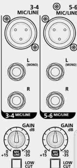
**INGRESSO STEREO LINE (C. 3/4 - C. 5/6)** Consente di collegare una tastiera o dispositivi a segnale di linea stereo. Scala guadagno +15 dB/-35 dB (C. 3/4 - C. 5/6). Durante l'uso degli ingressi MIC 3/4 o 5/6, i canali corrispondenti funzionano come canali mono.
