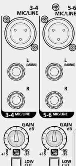
**Entrada STEREO LINE (canal 3/4 - canal 5/6)** Aquí se conectan el teclado, los dispositivos estéreo o de nivel de línea. Escala de ganancia +15 dB/-35 dB (canal 3/4 - canal 5/6). El canal correspondiente funciona como canal mono cuando se utiliza la entrada MIC del canal 3/4 o 5/6.
