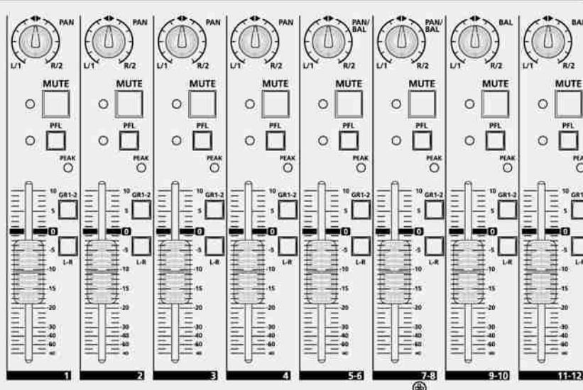
**FADERS canal 1 – canal 4:** Control de nivel de canales MONO
