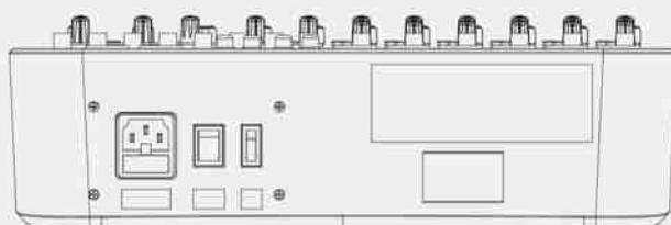
**PRISE VDE CA** Prise VDE CA pour la connexion du mélangeur à l'alimentation électrique CA.
