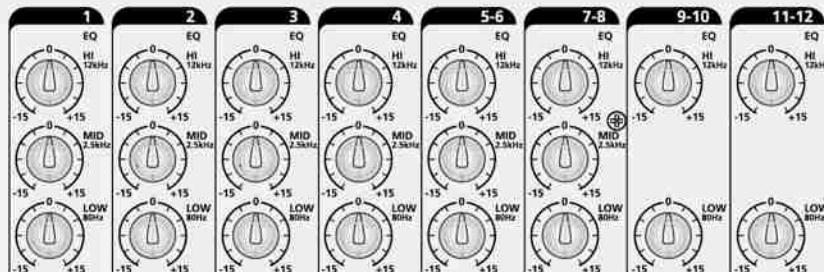
**AUX1:** comando di mandata ausiliario, livello da -∞ a +15 dB. Il segnale viene inviato al connettore jack dell'uscita AUX1 SEND. La funzione POST/PRE determina se estrarre il segnale secondo la posizione del fader o indipendentemente da essa.
