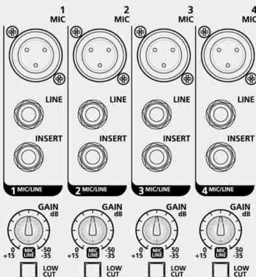
**Ingresso LINE (C. 1-C. 4)** Consente di collegare i dispositivi a segnale di linea ai seguenti connettori TRS: punta=Caldo, anello=Freddo, manica=Terra. Questi ingressi sono indicati per preamplificatori esterni o DI-box. Scala guadagno +15 dB/-35 dB.
