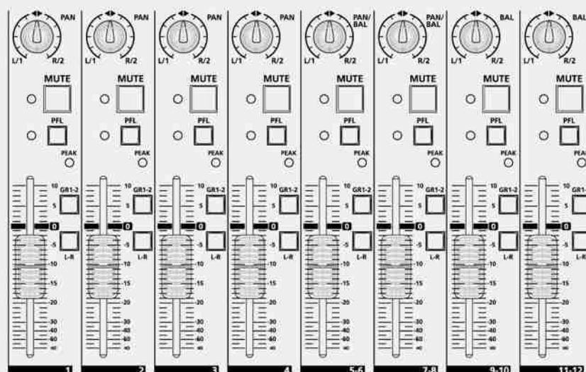
**MUTE Schalter:** Mit diesem Schalter wird der Kanal stummgeschaltet (rote LED ein).
