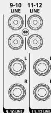
**STEREO-RETURN** Verbinden Sie Signale von externen Geräten wie beispielsweise FX Module mit diesen unsymmetrischen TRS-Klinken.
