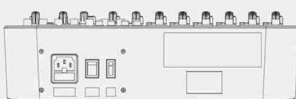
**VDE NETZANSCHLUSSBUCHSE** Netzanschlussbuchse für den Anschluss des Mixers an die Netzstromversorgung.
