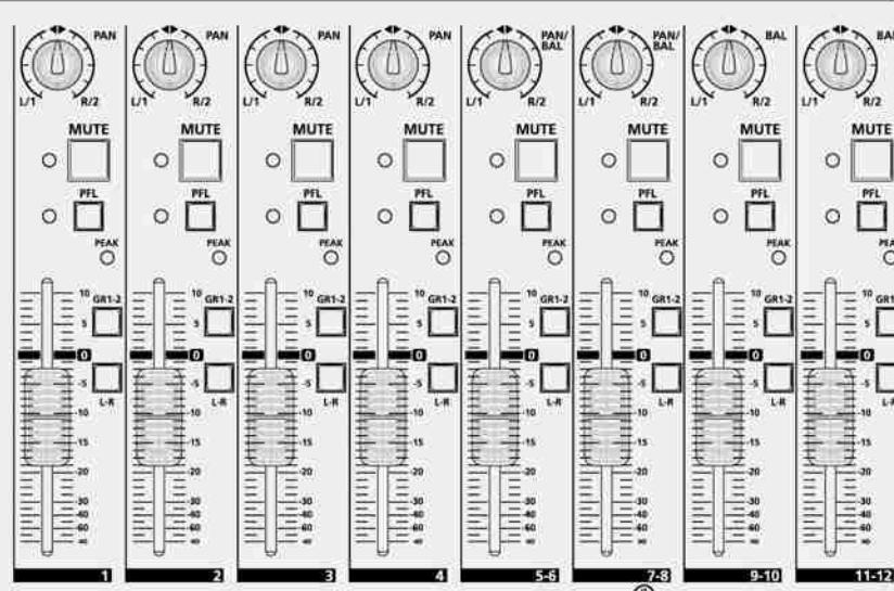
**FADER C. 5/6 - C. 7/8:** controllo del livello dei canali MONO/STEREO
