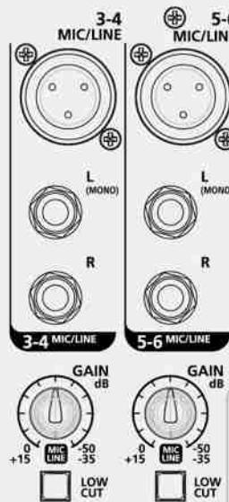
**Entrée STEREO LINE (Can. 3/4 - Can. 5/6)** Permet de brancher le clavier et les équipements stéréo ou de niveau de ligne. Échelle de gain +15 dB/-35 dB (Can. 3/4 - Can. 5/6). Le canal correspondant fonctionne comme un canal mono lorsque l'entrée MIC 3-4 ou 5-6 est utilisée.
