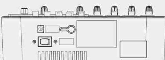
TOMA AC IN Permite conectar una fuente de alimentación externa de 18 V CA, 1000 mA.
