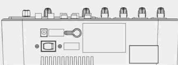
AC IN ANSCHLUSSBUCHSE für externe Stromversorgung 18 V AC – 1000 mA.
