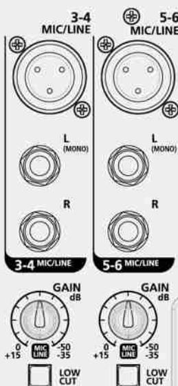
**STEREO LINE EINGANG** (K. 3/4 - K. 5/6) Schließen Sie Ihr Keyboard, Ihre Line-Pegel- oder Stereo-Geräte hier an. Gain Regelung +15 dB/-35 dB (K. 3/4 - K. 5/6). Der entsprechende Kanal arbeitet als Monokanal, wenn MIC Eingang 3/4 oder 5/6 benutzt wird.
