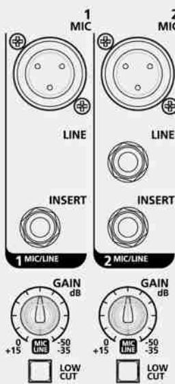
**Entrada MIC (canal 1- canal 5/6)** Los micrófonos se conectan a estos conectores XLR balanceados: clavija 1=tierra, clavija 2=fase, clavija 3=contrafase. Estas entradas reciben alimentación fantasma de +48 V para micrófonos de condensador o electret. Escala de ganancia 0 dB/-50 dB.
