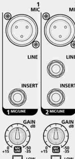
**Ingresso MIC (C. 1 - C. 5/6)** Consente di collegare i microfoni a questi connettori XLR bilanciati: pin1=Terra, pin2=Caldo, pin3=Freddo. Questi ingressi sono dotati di alimentazione phantom a +48 V per microfoni a condensatore o electret. Scala guadagno 0 dB/-50 dB.
