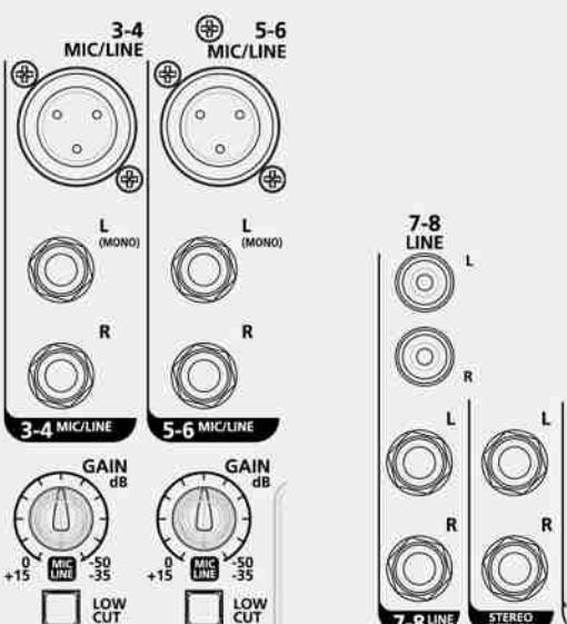
**Entrada STEREO LINE (canal 3/4 - canal 5/6)** Aquí se conectan el teclado, los dispositivos estéreo o de nivel de línea. Escala de ganancia +15 dB/-35 dB (canal 3/4 - canal 5/6). El canal correspondiente funciona como canal mono cuando se utiliza la entrada MIC del canal 3/4 o 5/6.
