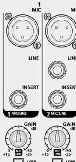
**Entrée micro (Can. 1 - Can. 5/6)** Permet de connecter les micros aux connecteurs XLR équilibrés suivants : Broche 1 = Terre, Broche 2 = Point chaud, Broche 3 = Point froid. Ces entrées sont fournies avec une alimentation fantôme de +48 V pour les microphones à condensateur ou à électret. Échelle de gain 0 dB/-50 dB.
