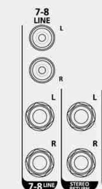
**Entrée RCA LINE (Can. 7/8)** Permet de brancher les équipements bas de gamme ou grand public, tels que les lecteurs de CD, les ordinateurs et les téléphones mobiles (adaptateur requis). L'entrée LINE (Can. 7/8) est également répliquée avec un jack 6,35 mm.
