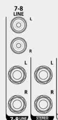
**RCA LINE EINGANG** (K. 7/8) Schließen Sie Ihre Low-level- oder Verbrauchergeräte wie CD Player, Computer oder Mobiltelefo-ne hier an (Adapter erforderlich). LINE EINGANG K. 7/8 wird auch mit 1/4" repliziert. Klinke.
