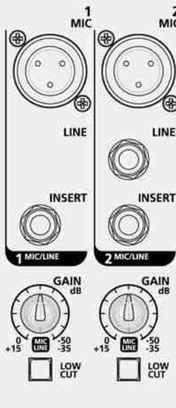
**MIC Eingang.** (K. 1 - K. 5/6) Schließen Sie Ihre Mikrofone an diese symmetrischen XLR Verbinder an: Pin1=Erde, Pin2=Hot, Pin3=Cold. Diese Eingänge haben eine +48 V Phantomspeisung für Kondensator- oder Elektret-Mikrofone. Gain Regelung 0 dB/-50 dB.
